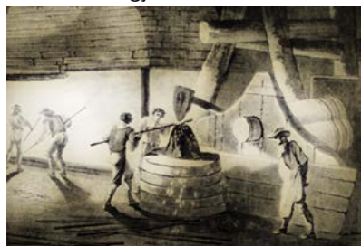
Lorentzen: Smeltehytte ved marsovnen. Flytende jern ledes til sandformer Under: Stangjernshammeren
