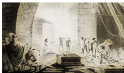
Lorentzen: Smeltehytte ved marsovnen. Flytende jern ledes til sandformer Under: Stangjernshammeren
